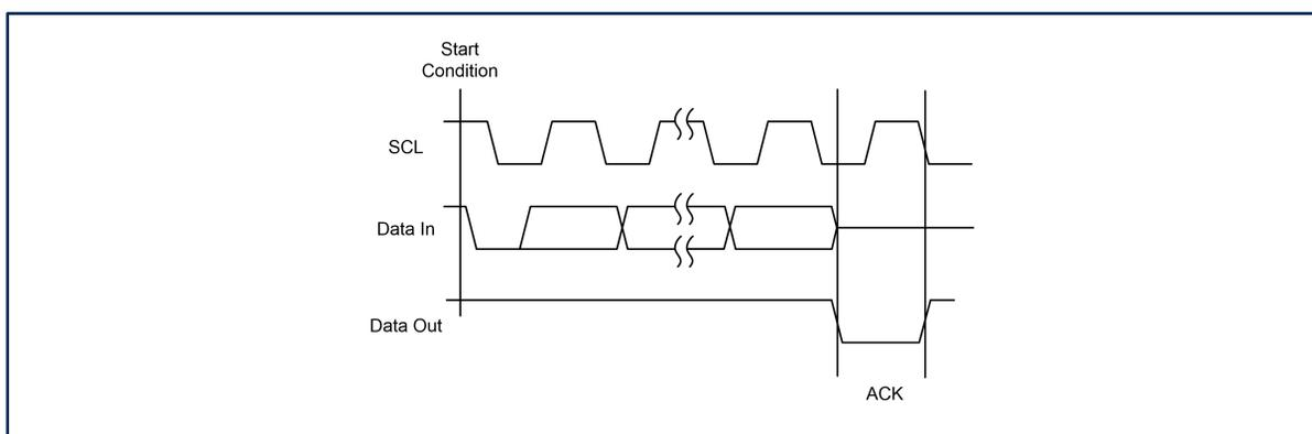
3.3.3 如下图设置地址0x02，将12bit DATA数据分为DATA Low和DATA High写入，DATA Low 为低Byte，DATA High为高Byte，并且无视DATA Low 的低4位。
