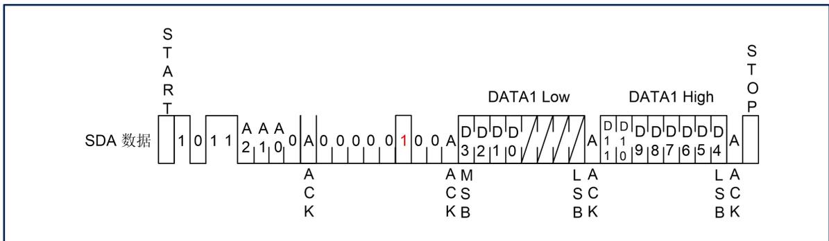
**3.3.5** 设置下图红色配置位，地址设置为02，并对VOUT0和VOUT1同时进行操作。将12bit DATA0数据分为DATA0 Low和DATA0 High写入，DATA0 Low为低Byte，DATA0 High为高Byte，并且无视DATA0 Low的低4位。如果是0-10V模式，则输出相对应的电压为： $VOUT0=DATA0/0xFFF*10V$ 。如果是0-5V模式，则输出相对应的电压为： $VOUT0=DATA0/0xFFF*5V$ 。
